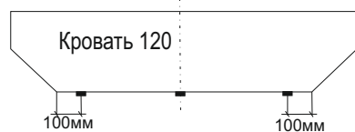
Схема установки подпятников
